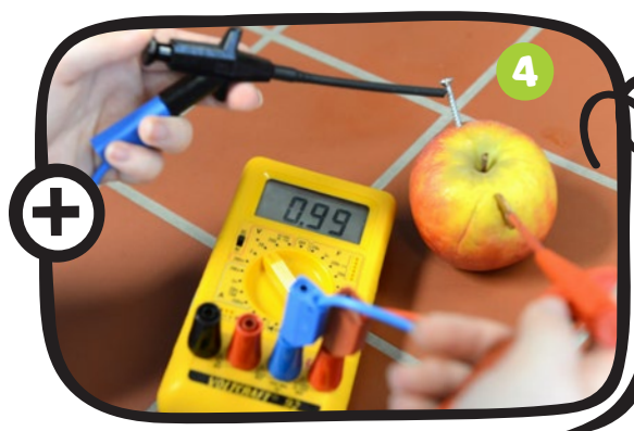
Verbinde mit dem anderen Kabel die Schraube mit dem Pluspol des Multimeters.
